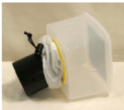
Figura 3: contenitore per la raccolta degli insetti e tubo di aspirazione assemblati.
